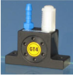
Los vibradores tipo GT producen una vibración ondulatoria que entra en resonancia con el producto muchísimo mejor que los vibradores lineales. La frecuencia puede ser ajustada usando reguladores de presión o de caudal de aire.
